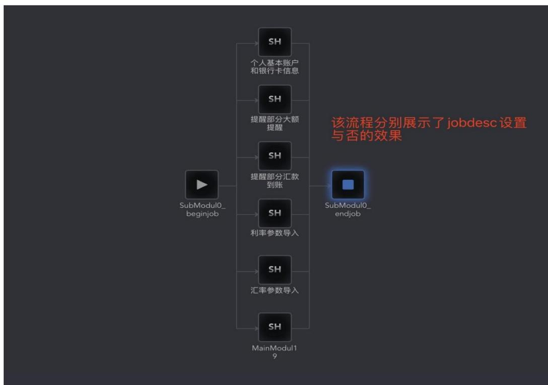
由图可知，对于设置了作业描述属性的作业，平台工具软件可以直接展示汉字说明信息，这使流程图变得更直观、更易理解。
